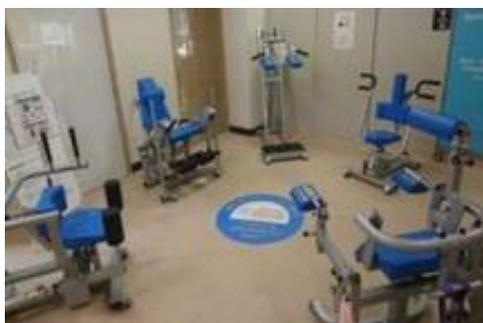
油圧式マシンの一番の特長は、常に利用者が発揮した力と同じだけの抵抗力が生まれることです。「高齢者に筋トレマシンは無理」との声もありますが、油圧式マシンは動かす速さで運動負荷が調節されるため、小さな力でも動くので、高齢者でも気軽に運動できます。早く動かせば重くなるし、低体力者でもゆっくり動かせば軽いので無理なく運動を続けられます。また、押す時も引く時も負荷がかかることから、往復運動で表裏の筋肉を同時に鍛えられるほか、ウエイト式負荷のように力を抜いても勝手に戻らないため安全です。
